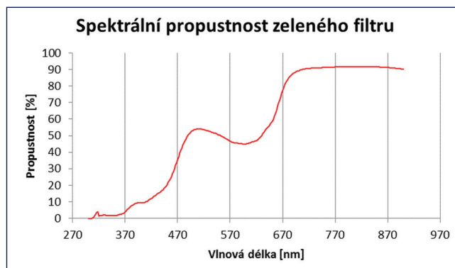
Obr. 1 Spektrální charakteristika zeleného chromagenového filtru
